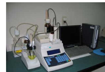
カールフィッシャー滴定装置 試料中の水分を測定
