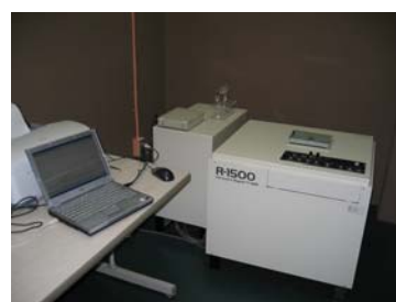
核磁気共鳴(NMR)装置 分子の構造(水素の位置)を測定
