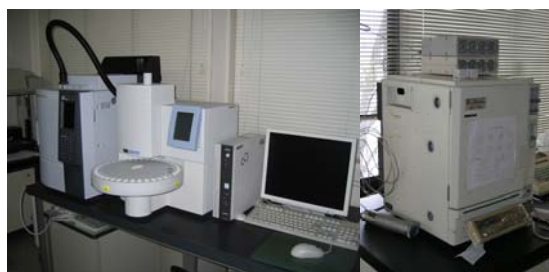
ガスクログラフィー 有機化合物(混合物)を 分離、検出し、純度を測定
