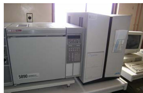
ガスクロマトグラフ質量分析装置 有機化合物(混合物)を分離、検出し、分子量を測定
