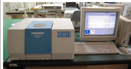
赤外分光装置(FT-IR) 分子の構造(官能基の種類)を測定
