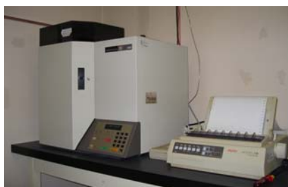
元素分析装置 分子中の炭素、水素、窒素、 の割合を測定
